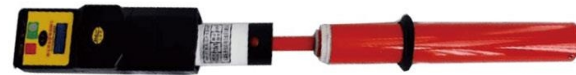
被检测验电器声光警报即为检测合格
